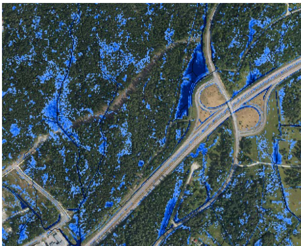
Från DHI:s detaljerade skyfallsberäkning över Örebro. Maxdjup vid ett 100-års regn. Mörkare blått betyder djupare vatten.
